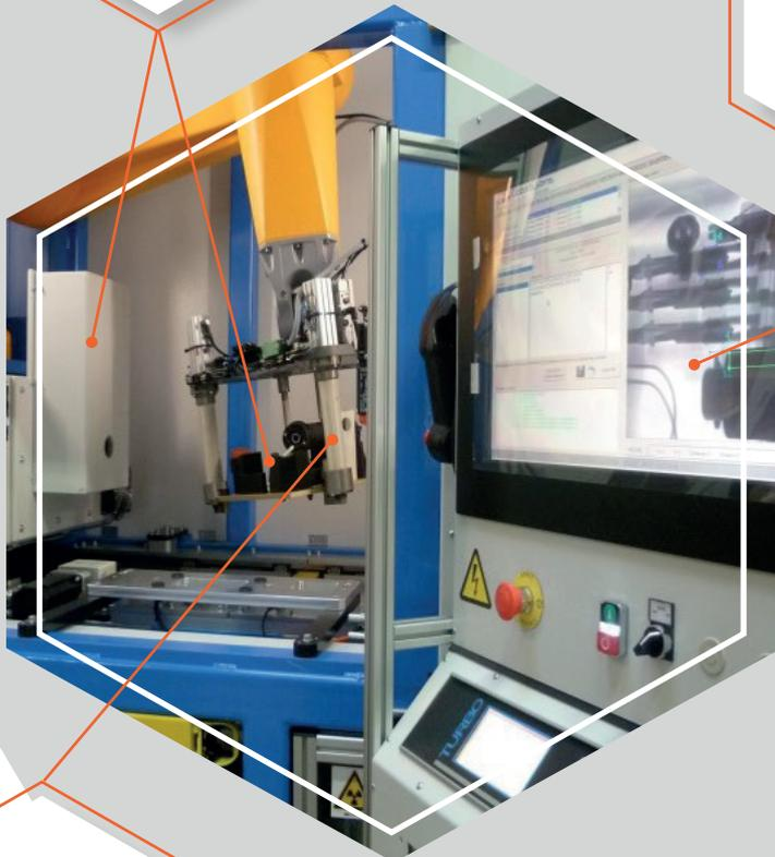
**La manipulation des pièces est automatisée** à l'aide de robots, convoyeurs, etc. Elles peuvent être triées automatiquement sur la base des contrôles effectués.
